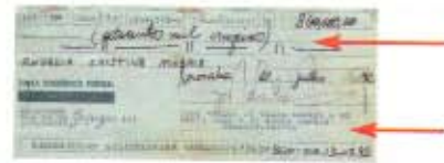
Figura 34: Cheque questionado, observando-se a assinatura executada com instrumento escrevente diferente do preenchimento.
