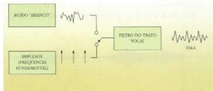
Figura 1.5 Diagrama para o modelo Fonte + Filtro [5]. A fala resultando da filtragem realizada pelo trato vocal, de impulsos que se alternam como periódicos ou aperiódicos
