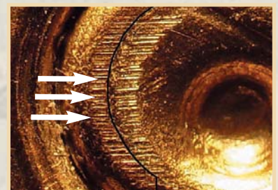
Figura 8 - Fotografia do confronto das marcas de culatra estampadas à esquerda do sinal de percussão. As setas indicam as marcas coincidentes em ambas as cápsulas.
