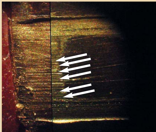
Figura 6 - Fotografia do confronto de marcas presentes no projétil questionado, à esquerda da linha preta, e em um padrão coletado pelos peritos, à direita da linha preta. As setas indicam as marcas coincidentes mais evidentes e que confirmam que ambos os projéteis foram expelidos pelo cano da mesma arma de fogo.
