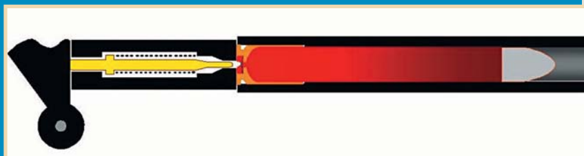
Figura 4 - Ilustração mostrando o movimento do projétil devido ao brusco e intenso aumento de pressão resultante da queima da pólvora.
