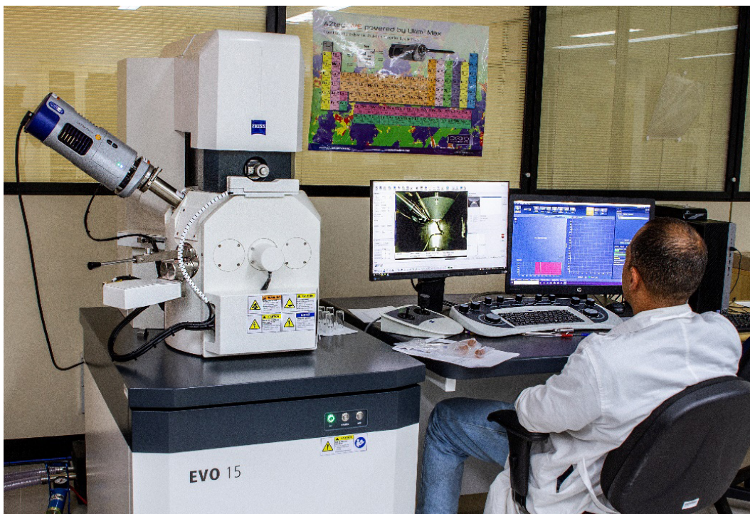
Figura 2 – Análise de resíduos de disparo por microscopia eletrônica.
