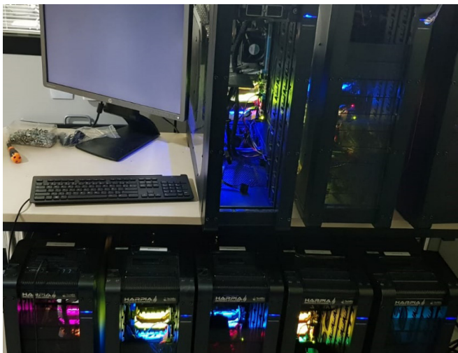
Figura 3 – À esquerda: cluster de 8 Servidores de Transcrição com 16 placas GPUs de alta performance. O Cluster do INC é capaz de transcrever até 1.500 segundos de áudio em apenas 1 segundo e presta serviço a todas as unidades de criminalística do Brasil. À direita, texto transcrito de forma automática e com acurácia de mais de 90% de acerto.
