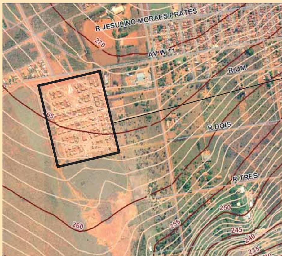
**Fig. 5** – Fotografia aérea georreferenciada agregada a um SIG. As curvas de nível, lançadas em intervalos de um metro, auxiliam na contextualização espacial e locacional da obra em exame
