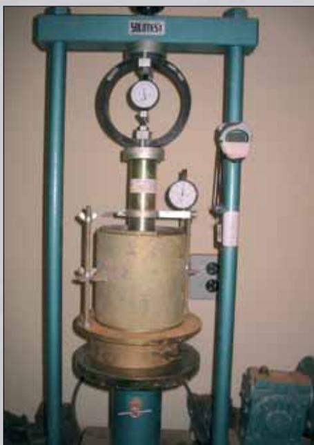
Foto 3 – Execução do ensaio de ISC, em laboratório
