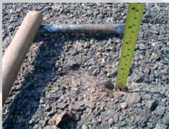
Foto 6 – Medida de espessura da capa de asfalto
