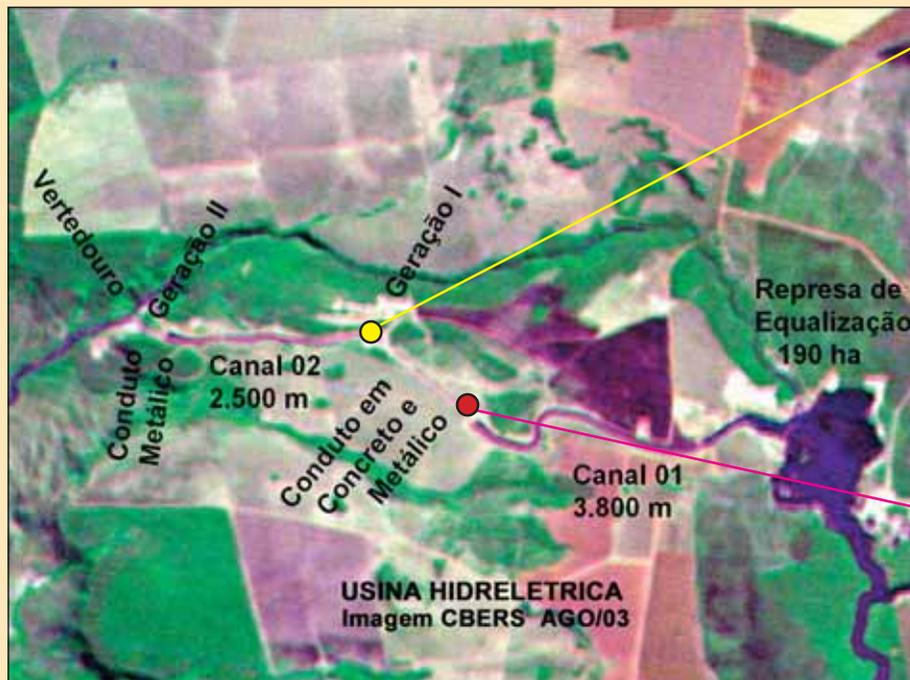
**Fig. 2** – Imagem do satélite CBERS (ago/03), mostrando a área de implantação de uma usina hidrelétrica, podendo ser observado o leito original do curso d’água, a represa, dois canais de adução e, identificados em conjunto com o projeto básico da obra, os condutos, casas de máquinas (geradores) e vertedouro
