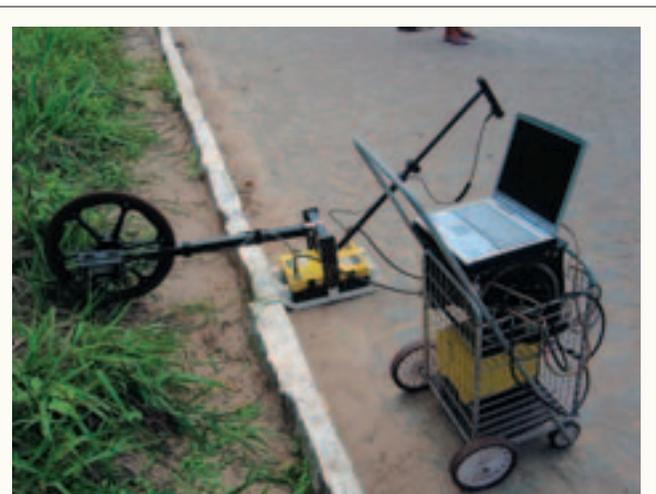
**Figura 04** – Exemplo de radar de penetração do solo (GPR). Equipamento do Instituto de Geociências da Universidade de Brasília
