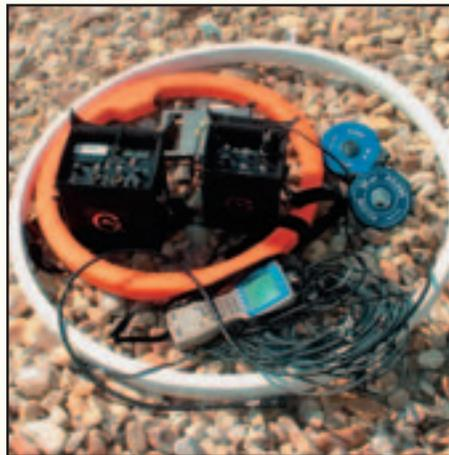
**Figura 02a** – Exemplo de condutímetro eletromagnético
