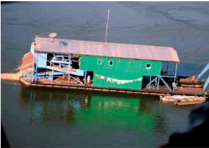
Figura 2. Draga escariante: embarcação de 27 metros de comprimento por 7 metros de largura, com lança (tubulação para perfuração e extração de material do fundo) medindo 28 metros de comprimento
