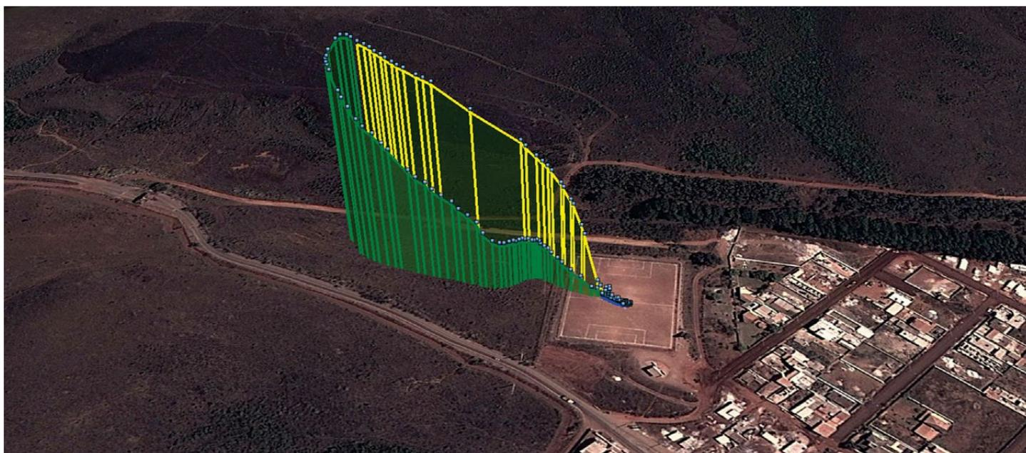
Figura ilustrando o trajeto real de voo sobreposta ao programa computacional Google Earth (em verde, o retorno automatizado ao ponto de decolagem).
