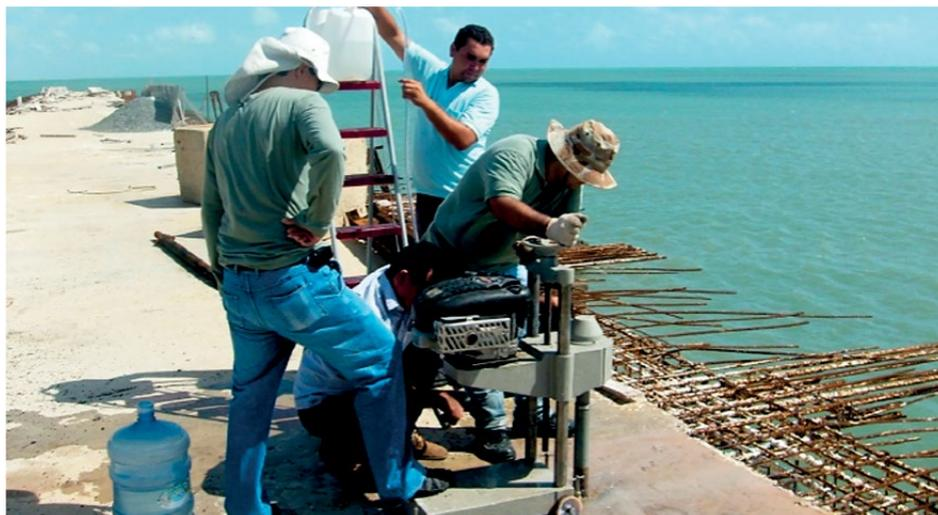
Extração de testemunho da estrutura de concreto do cais do porto de Luís Correia por extratora rotativa com broca de 2"
