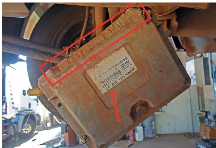
Caixa metálica que acondicionava o rádio transceptor no compartimento do motor. Note-se a etiqueta do fabricante (seta) e a porção com solda plástica (retângulo vermelho) situadas na parte inferior da caixa que, quando instalada no veículo, somente se tornaria possível sua visualização levantando-o.
