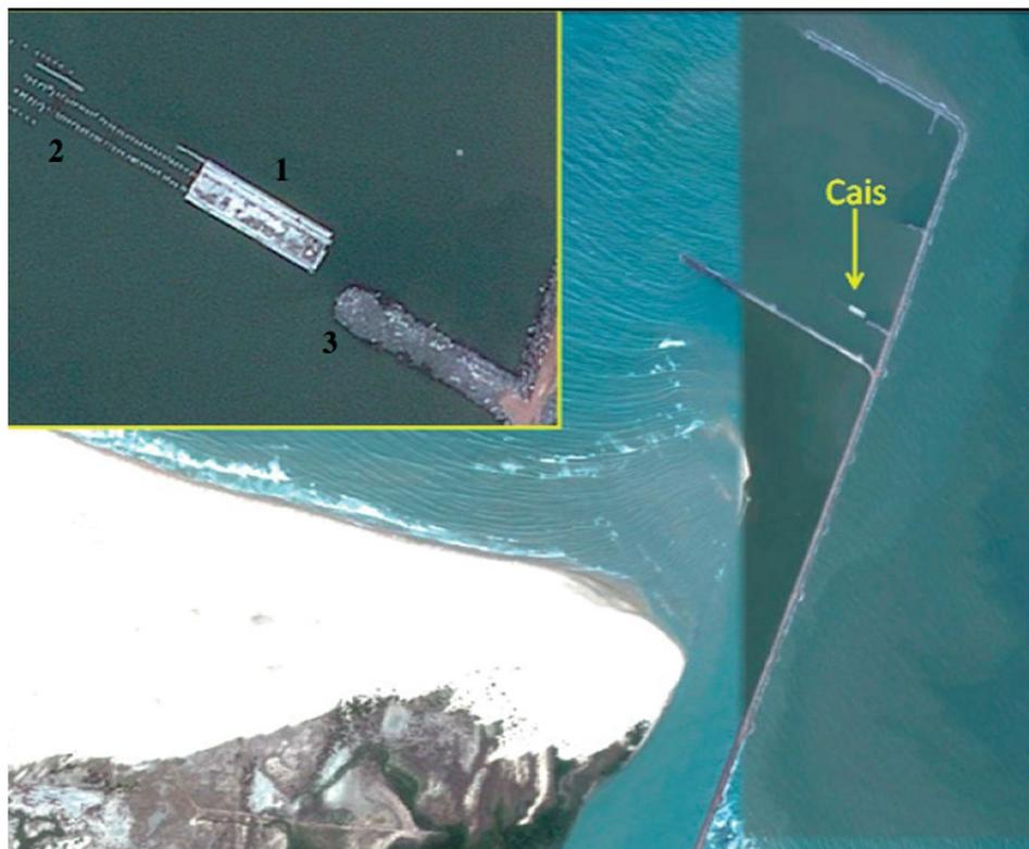
Imagem dos molhes e cais do porto de Luís Correia/PI em 30/10/2009, antes das obras questionadas. No canto superior esquerdo detalhe do Módulo I (1), das estacas do Módulo II (2) e do molhe de acesso (3) ao cais do porto parcialmente construído
