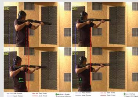
Ensaio com análise de quadros sucessivos de vídeo para comparação de recuos em disparos com munições reais versus festim.
