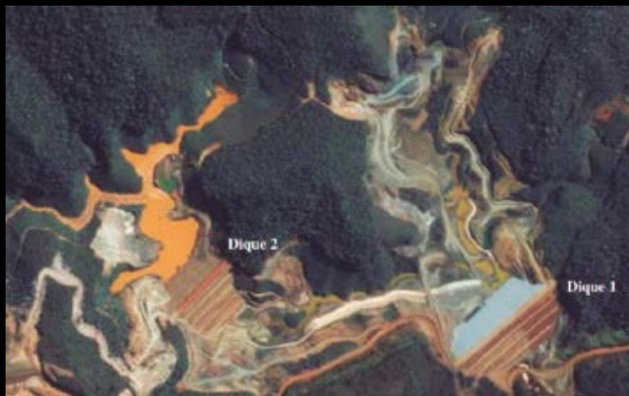
Imagem aérea do Sistema de Rejeitos de Fundão, logo após o término da sua implantação, onde visualizam-se os Diques 1 e 2.
