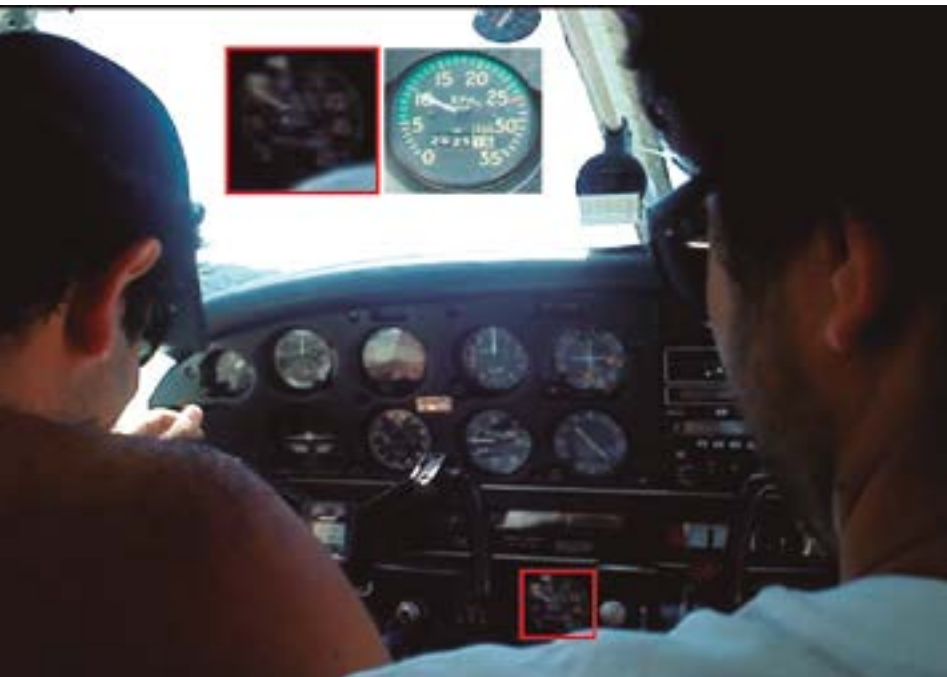
Figura 4: Visualização do tacômetro da aeronave sinistrada durante o aquecimento do motor da aeronave previamente à decolagem, notando-se, no detalhe, o realce da indicação constatada de 1.000 rpm (em contraste com outra imagem com melhor resolução da mesma indicação).
