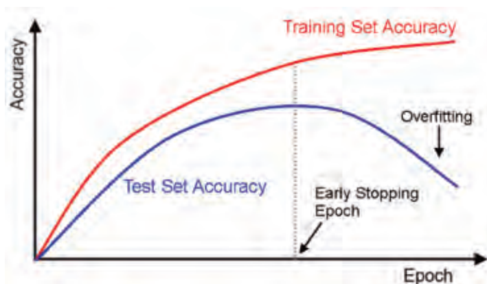
Figura 9 – Progresso de uma rede neural, ilustrando o ponto de melhor resultado do treinamento.
