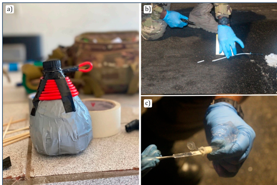
Figura 04 - a) Contra carga específica para desmontagem; b) coleta do sistema de iniciação do material explosivo; c) coleta da carga explosiva principal.
