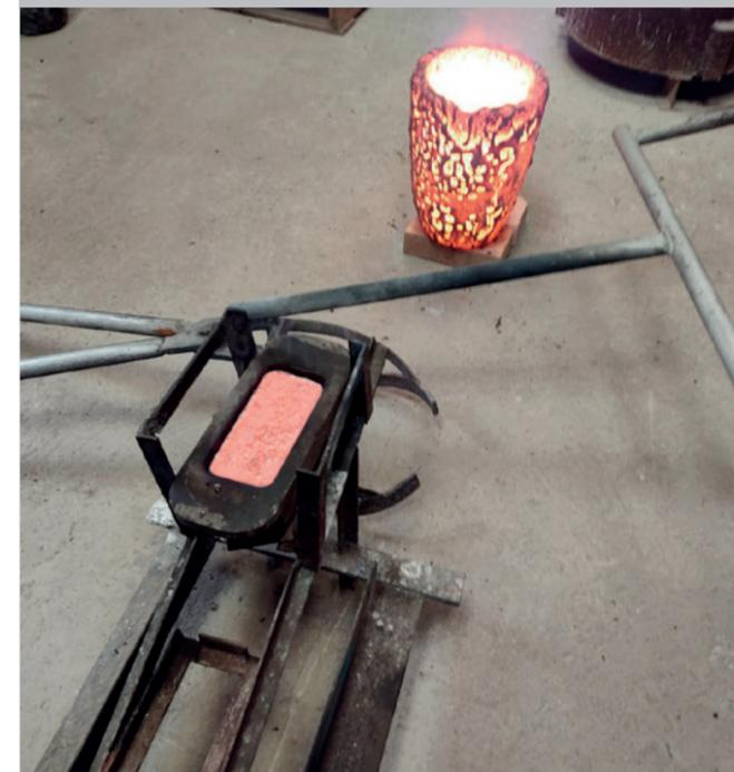
**Figura 04:** Bullion de ouro – ouro semirrefinado produzido nas fundições das minerações – contendo acima de 70% de ouro e tendo a prata como principal impureza.
