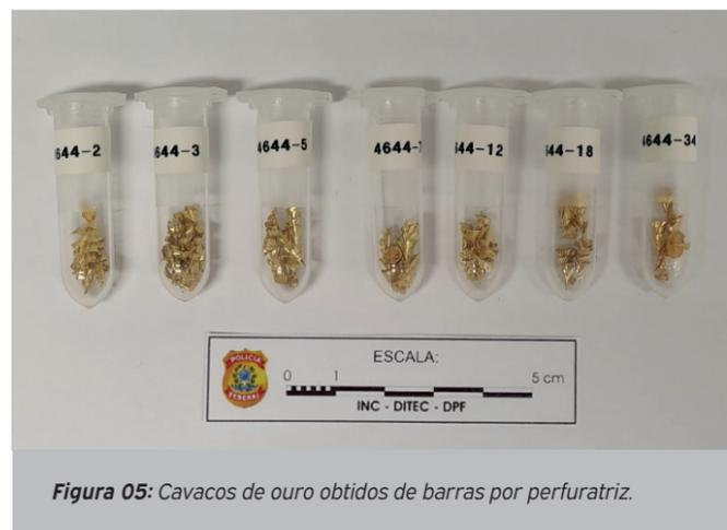
Figura 05: Cavacos de ouro obtidos de barras por perfuratriz.
