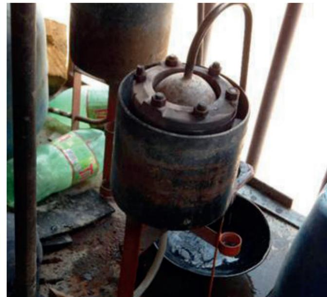
Figura 06: Modelo de uma recuperadora de mercúrio e modelo real encontrado em garimpos. Laudos 228/22 e 964/22 SETEC/AM.
