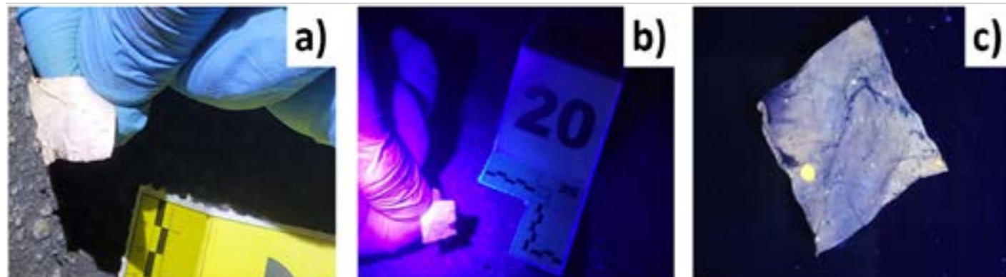
Figura 10: a) Sensor com resíduos de pós-explosão sob luz visível; b) detecção de resíduos de pós-explosão in loco; c) revelação de resíduos de pós-explosão com o sensor sob luz UV (365nm). Fonte: os autores.
